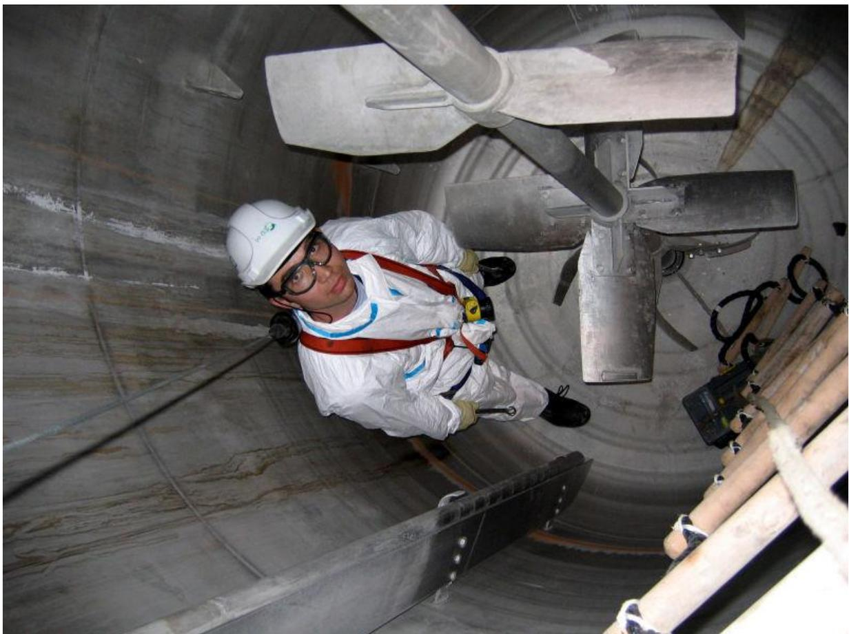
Sezione Fermentatore CSTR con turbina Rushton
