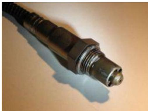
La sonda Lambda è in grado di rilevare la concentrazione di ossigeno all'interno dei gas di scarico; precisamente il valore di lambda, appunto, che sta ad indicare l'esatto rapporto tra l'aria e la benzina, dove:
